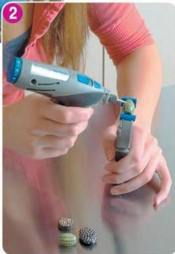
потренируйтесь на какой-нибудь ненужной детали. **2** Чтобы декорировать уже покрашенную заготовку, мы фиксируем её в струбцине, вставляем в наш Dremel Stylus алмазную грави-
